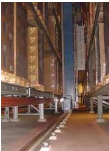
Передача электроэнергии и управляющих сигналов на кран в условиях склада для хранения продуктов, требующих глубокой заморозки
